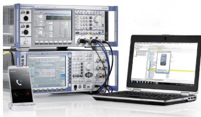
图2 R&S公司开发的完整VoLTE语音质量自动化测试系统
