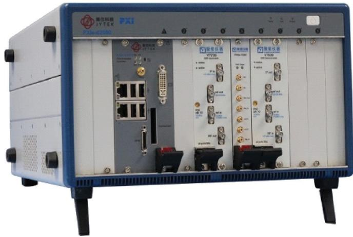
图3 聚星仪器射频识别监测仪
