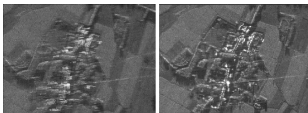
(a)代表传统PGA处理 (b)代表改进PGA处理 图 6 高分机载 SAR 传统 PGA 和改进的距离向空变 PGA 自聚焦图像对比
