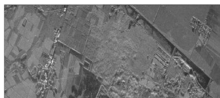
图 7 基于 CPU+GPU 的机载高分 SAR 运动补偿和自聚焦结果
