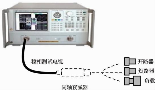
图3 双端口矢量网络分析仪试验示意
