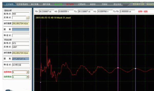
图 11 短路故障测试示意
