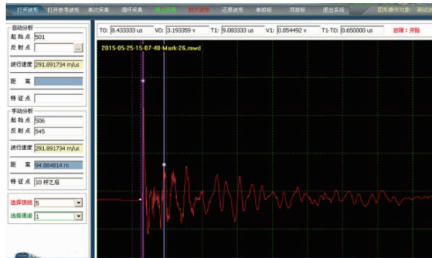
图 10 开路故障测试示意
