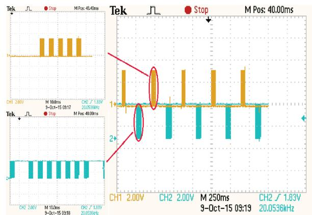
图10 步进电机整步工作 A 相的 PWM 脉冲序列
