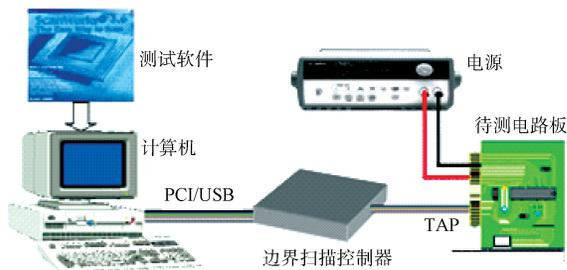
图1 系统结构组成
