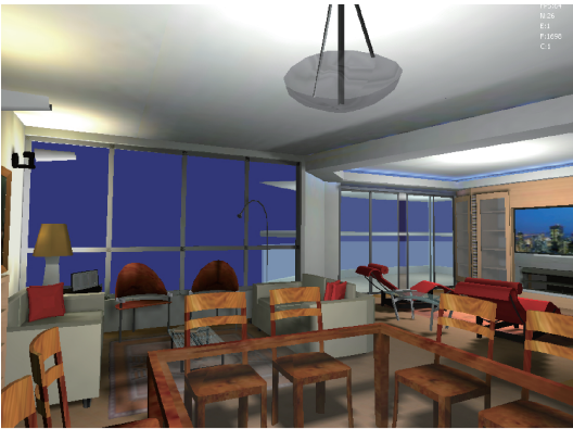
图5 GPU硬件加速的复杂场景辐射度光照效果
