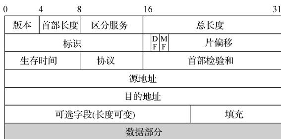
图6 IP包头格式示意
