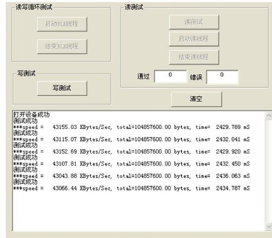
图8 USB同步Slave FIFO读写测试
