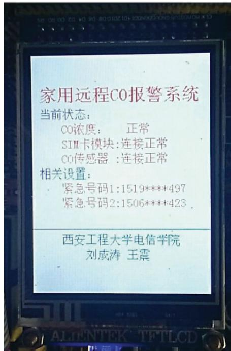
图 5 液晶屏状态显示结果
