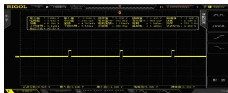
图10 客户端向服务器发送数据示波器波形
