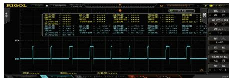
图8 服务器向客户端发送数据示波器波形
