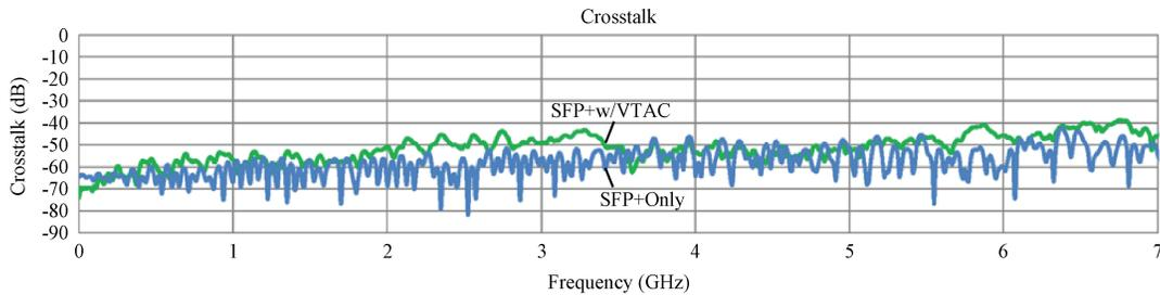
图3 中间加上了VTAC HSD接口和没有VTAC HSD接口的两根1 m长SFP+线缆的串扰对比,在高达10 000次的插拔之后,这个结果还是保持一致
