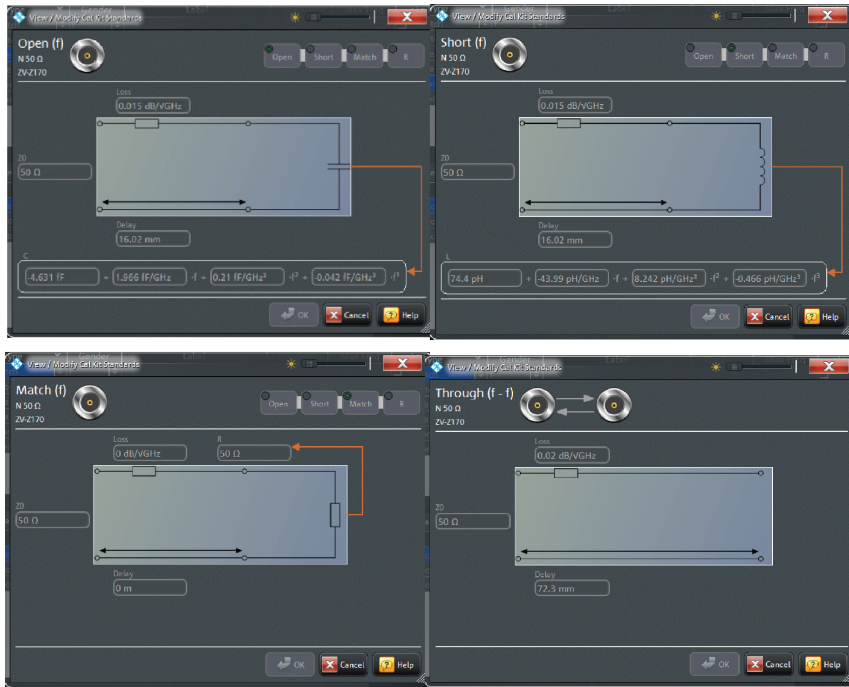
图3 常用校准件的电路模型，特征数据描述了校准件的不理想性
